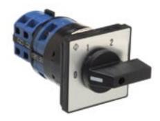
Переключение с устройством "на себя " и "от себя" возможно только нажав от себя ручку или потянув ее на себя. Устройство блокировки можно установить на определенные позиции. Вспомогательные контакты можно использовать с помощью движения по направлению оси. В переключатели типоразмера S0 может быть добавлено 2 вспомогательных контакта и установлен индикатор последнего положения.
