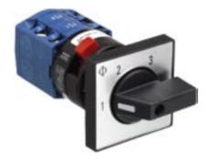
Переключатель с центральным креплением устанавливается примерно в 5 раз быстрее, чем переключатель с креплением на лицевой пластине. Для его установки необходимо только одно монтажное отверстие диаметром 16, 22 или 30 мм. Код центрального крепления определяется в зависимости от типоразмера переключателя, диаметра отверстия и наличия лицевой панели.
